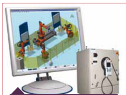
Logiciel Delmia pour la simulation virtuelle d'une ligne robotisée.
