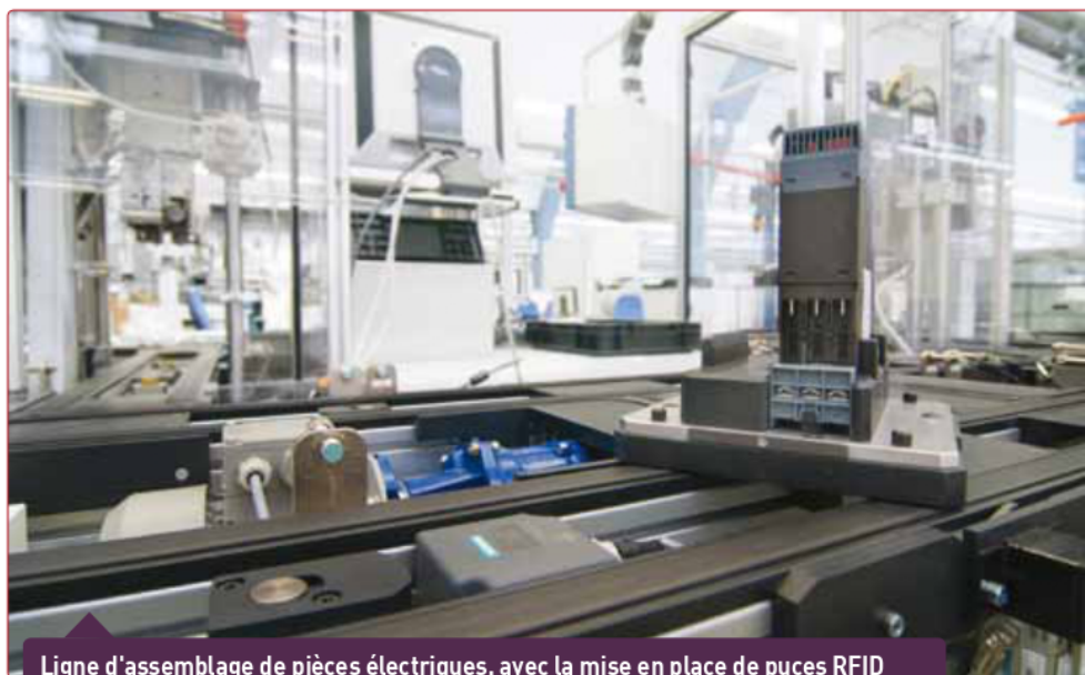
Ligne d'assemblage de pièces électriques, avec la mise en place de puces RFID sur les palettes afin de suivre la production de bout en bout.
