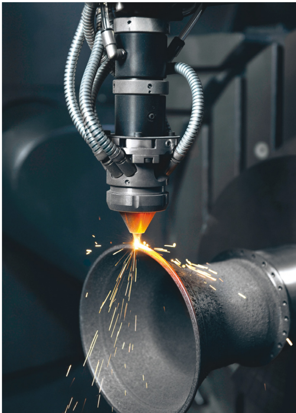
Machine d'usinage 5 axes doté d'une tête Clad permettant de réaliser des pièces en fabrication additive.
